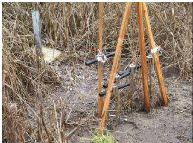
Figure 8 : Photo des cannes de prélèvement
