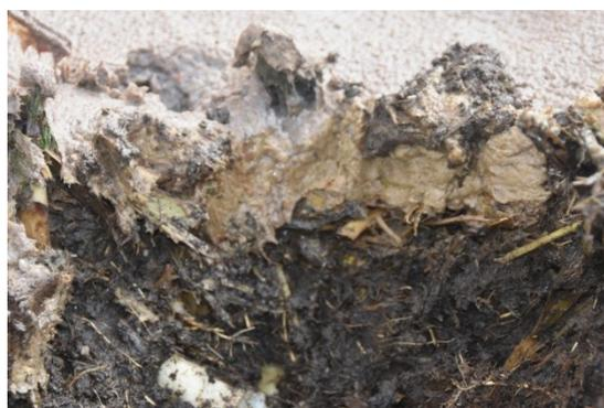
Figure 16. Formation d'une couche colmatante (beige clair) parfois appelée *slime* au-dessus du dépôt de surface.
