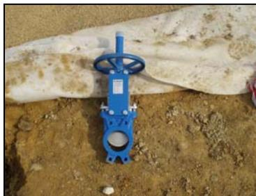
Vannes guillotines à volant
