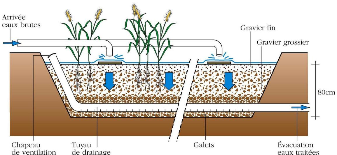
Figure 1 : Coupe transversale schématique d'un filtre à écoulement vertical<sup>1</sup>
