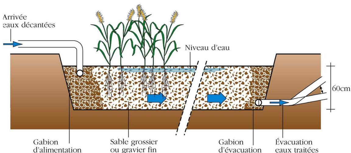
Figure 2 : Coupe transversale schématique d'un filtre à écoulement horizontal<sup>2</sup>
