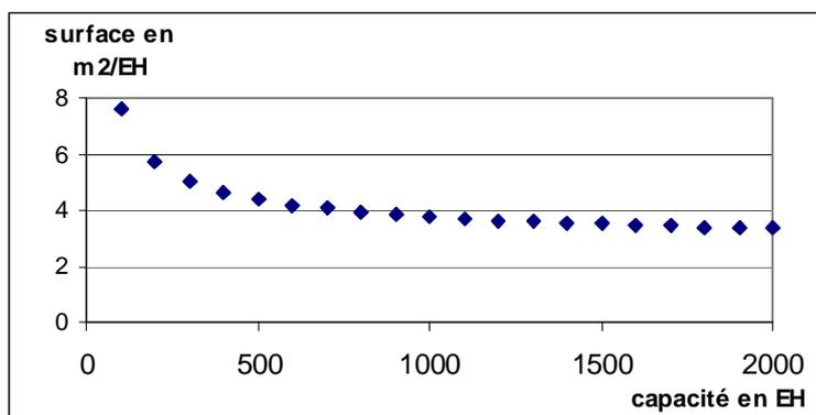
Figure 3 : Surface brute nécessaire en fonction de la capacité de la station en habitant.<sup>3</sup>
