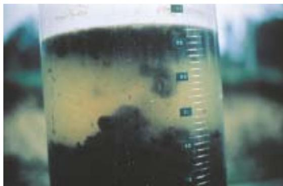
Figure 11 – Décantation en éprouvette – Remontée de boue
