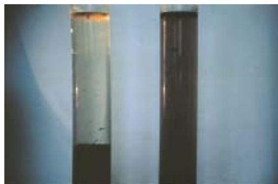
Figure 5 – Tests en éprouvettes – présence de flottants
