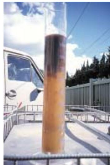
Figure 10 – Test en éprouvette – Remontée de boue
