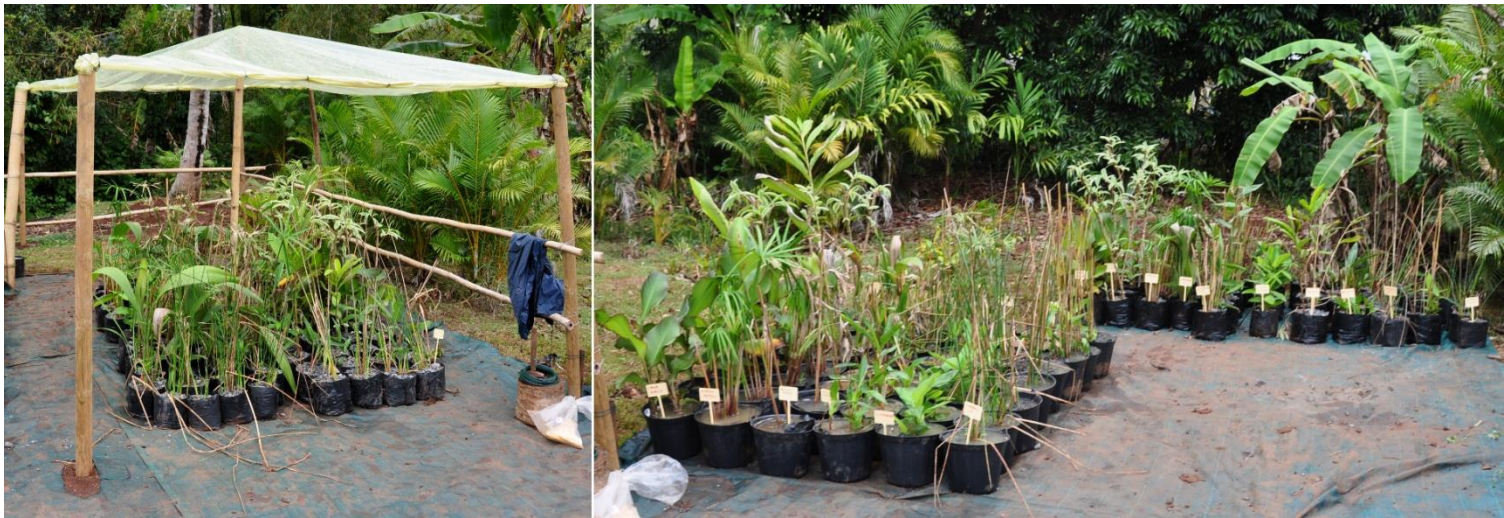
Figure 8 : Installations expérimentales à la pépinière de SEV. A gauche les lots en stress hydrique sont protégés des précipitations par une bâche. Au centre les lots en stress anoxique et à droite les lots témoins.
