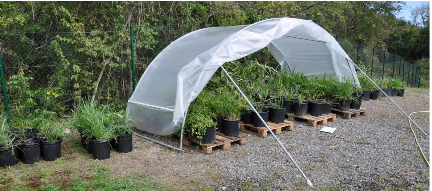
Figure 9 : Dispositif expérimental sur la station de Taupinière. A gauche les lots en stress anoxique. Au centre sous la serre les lots en stress hydrique permanent et périodique. Au fond les lots témoins.
