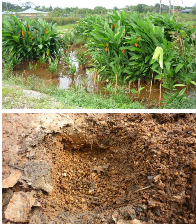
Figure 5 : colmatage du filtre 1 de BO1, les dépôts latéritiques sont visibles en surface, comme en profondeur, imperméabilisant le milieu.
