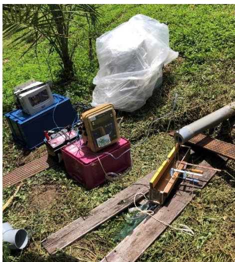
Figure 11 : Dispositif de mesure en sortie de FPV Gravitaire (Bilan CATAL 1-27/08/2020 ©ETiage Guyane)
